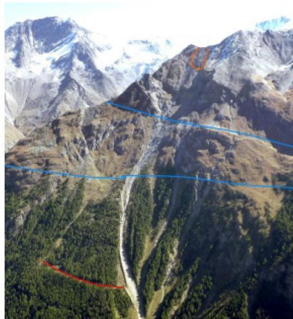
Gemessene Bewegungen der Felsrutschmasse seit Messbeginn (September 2013). Das kleine Bild zeigt eine Übersicht mit dem Schutzwall (rot), dem Ausschnitt der gefährdeten Wegabschnitte (blau) und die potenziellen Felssturz- und Felsrutschmassen (orange).
